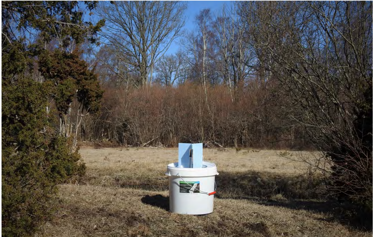
Figur 6. Portabel nattfjärilsfälla av typen LED-Emmer (Vlinderstichting, NL). Fällan drivs med en s. k. powerbank och aktiveras via en ljussensor. Fem LED-fällor per lokal är den inventeringsinsats som testats i Sverige under året samt den som rekommenderas i EU-PoMS (Potts m. fl. 2020). Utförlig information finns via: https://www.vlinderstichting.nl/wat-wij-doen/meetnetten/meetnet-nachtvlinders/ledemmers-info Foto: Leif Dehlin.
