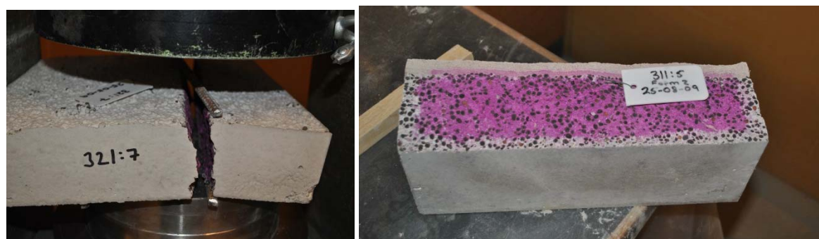
Bild 9. Vänster: En provkropp knäcks i en press vid två motstående armeringsjärn. Höger: Putsad provkropp med fenolftalein applicerad på den spräckta ytan.
