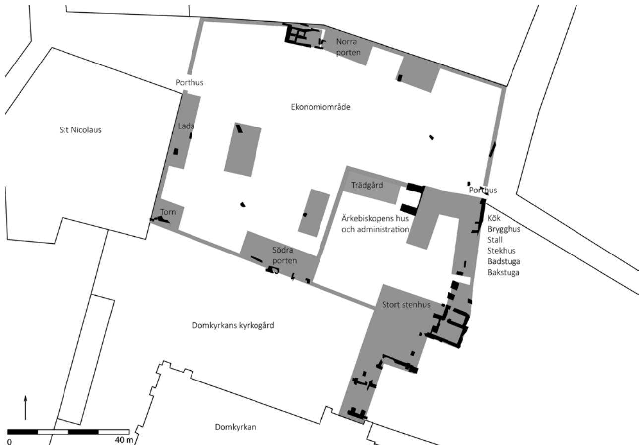
Figur 2. Plan över murlämningar i Lundagård. Svarta markeringar visar murlämningar medan de grå markeringarna är tolkade byggnader. Ritning: Gertie Ericsson, Kulturen.
