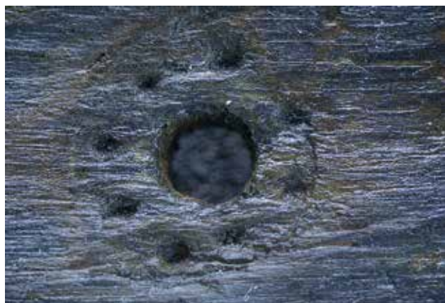
Figur 2. Et aftryk efter en klinknagle med otte pigge under hovedet på en reparationslap eller smal bordplanke fremstillet af nåletræ (NMU 1469 x134B) fra Roskilde 2-skibsfundet. Foto: Ivan Conrad Hansen, Vikingskibsmuseet i Roskilde, 2001.
