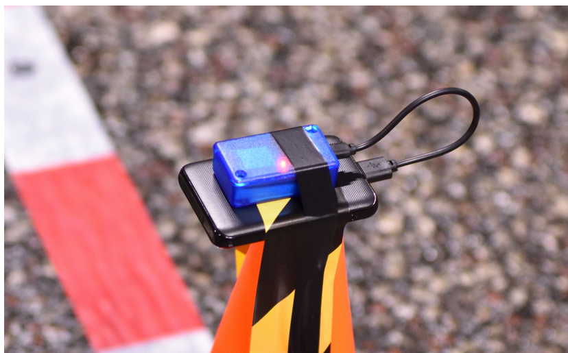
Figur 4. Wifi-apparat med batteri som användes under försöken för att representera en mobiltelefon.
