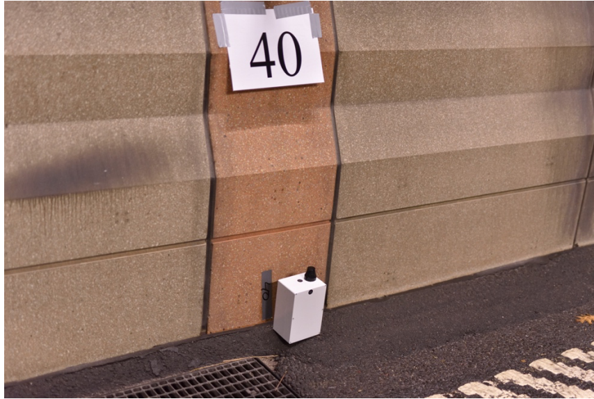
Figur 6. Avståndsmarkering på vänstra sidan och en utplacerad accesspunkt.
