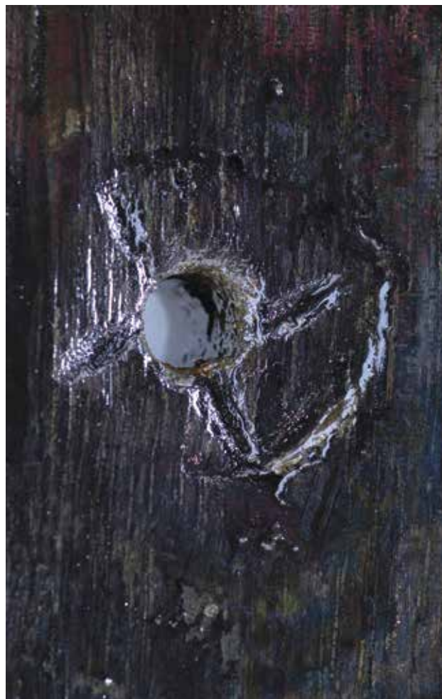
Figur 3. Et aftryk fra et klinknaglehoved med krydsfurer på undersiden på en reparationsplanke af spejlklovet egetræ (NMU 1482 x263) fra Roskilde 6-skibsfundet. Foto: Ivan Conrad Hansen, Vikingskibsmuseet i Roskilde, 2001.
