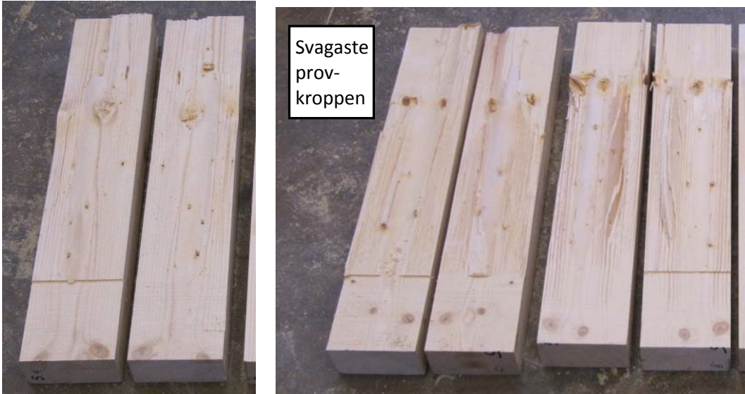
Provserie 2: rektangulärt tvärsnitt, b=115 mm
