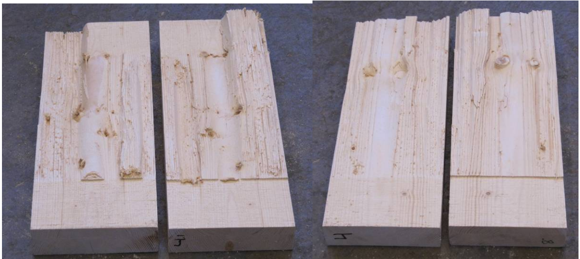
Proverserie 4: rektangulärt tvärsnitt, b=215 mm
