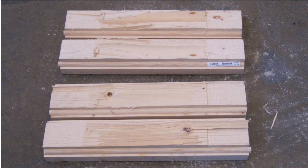
Proverier 6: tvärsnitt med I-form, b=77 mm
