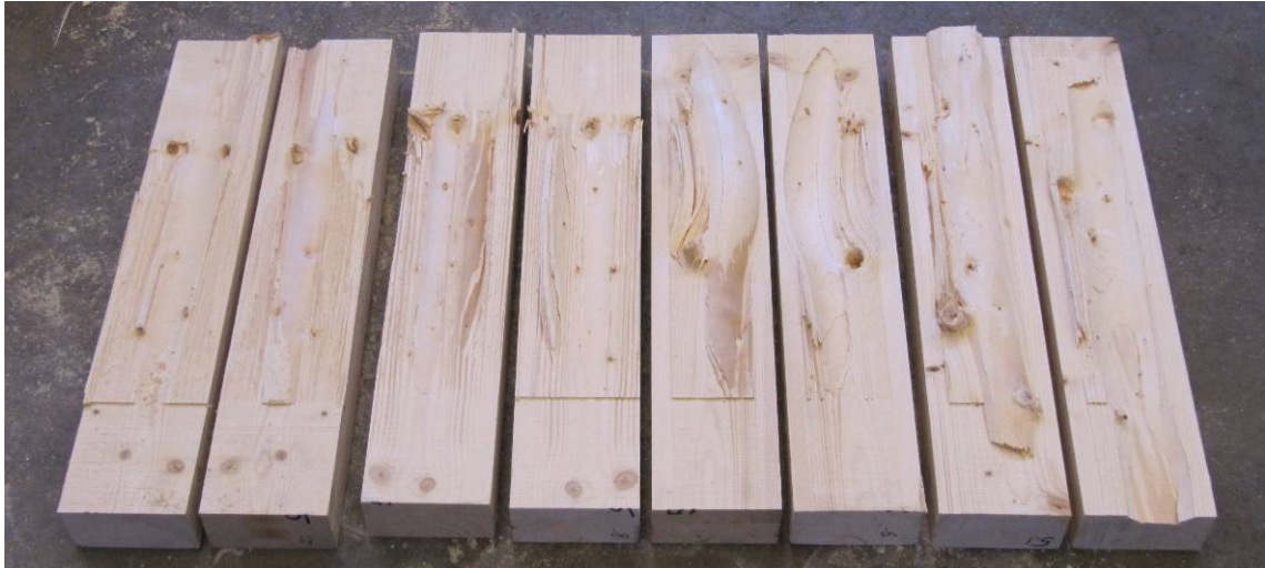
Proverier 5: tvärsnitt med sågat spår, b=77 mm
