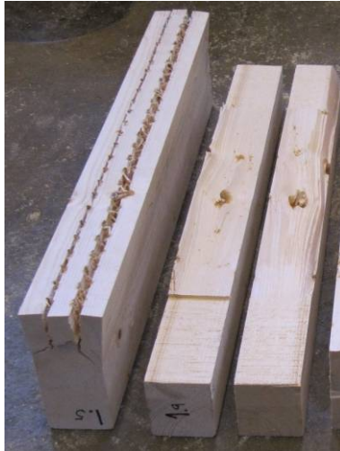
Provserie 1: rektangulärt tvärsnitt, b=56 mm
