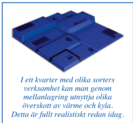
Överskottsvärme och kyla kan lagras i värmetröga byggnadsdelar, till exempel i ett parkeringsgarage. Där kan lämpligen taket isoleras och användas för värmelagring medan golvet utnyttjas för antingen kyla eller värme.
