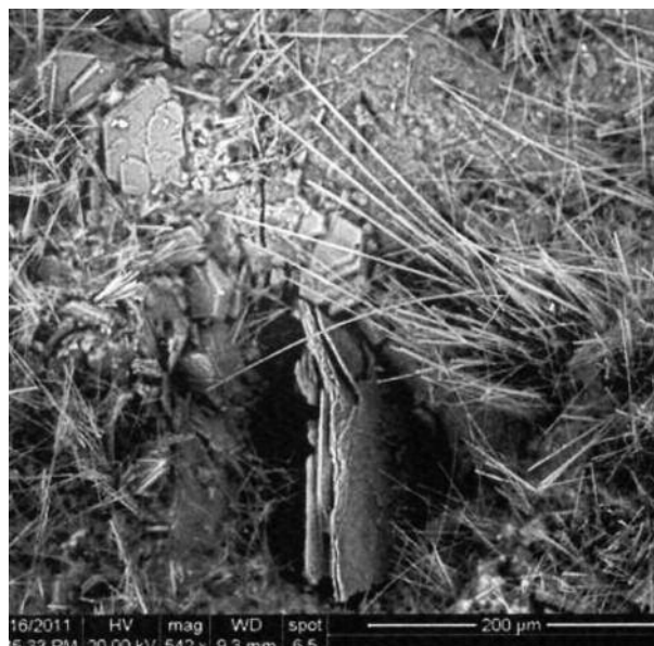
Figur 13: Utfällningar på sprickyta. Provet har varit helt nedsänkt i havsvatten under 28 månader. Sprickvidd 0,4 mm.
