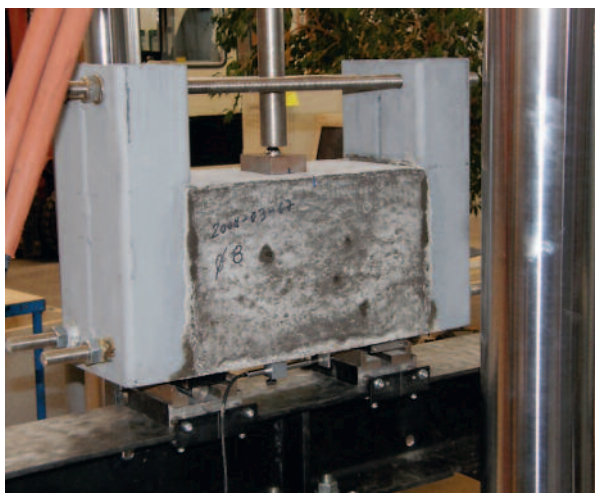
Figur 4: Prov under tillverkning av böjspricka.
