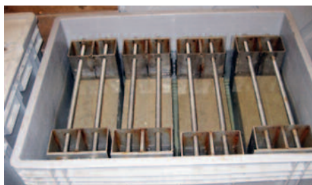
Figur 7: Exponering. Vänstra bilden: Typ 1, nedsänkta i vatten. Högra bilden: Typ 3, kapillärsugning från sprickfri överyta.
