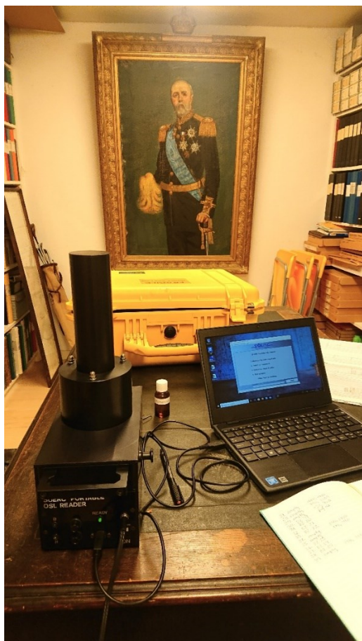
Fig. 4. Mätning för luminiscensprofilering med en "SUERC portable OSL reader" i ett rum på Falsterbo museum.
