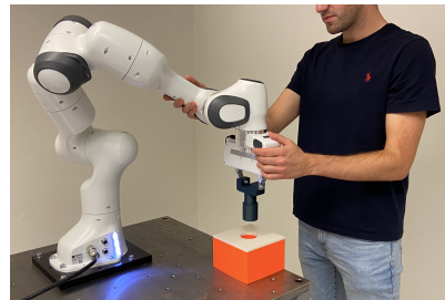
Un operador humano guiando manualmente a un robot para enseñarle una tarea de inserción.
