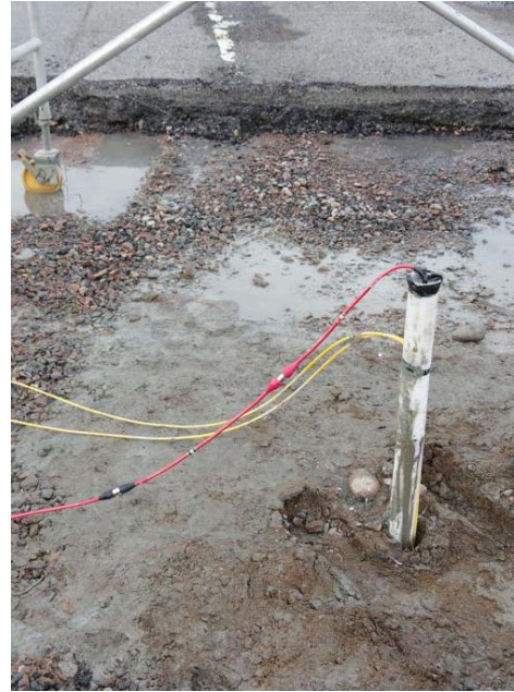
Figur 25. Fälttester med ERT i Göteborg, sommaren 2018. Här gjordes mätningarna med ERT-kablar för borrhålsmätning som fördes ner i slitsade grundvattenrör (Foto: Torleif Dahlin).
