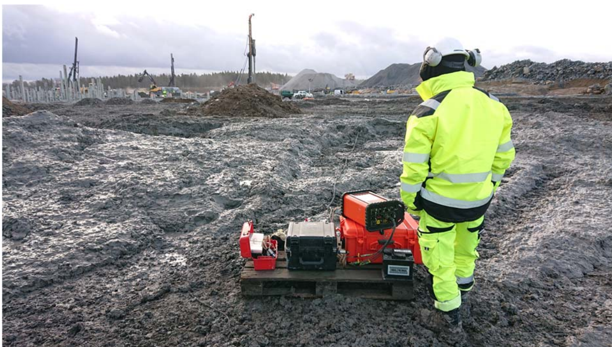
Figur 34. ERT-mätning med elektrodskabel i centrum av KC-pelare i Bålsta (Foto: Torleif Dahlin).
