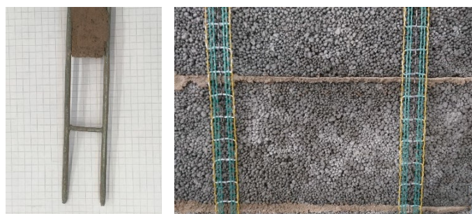
Bild 2.1 Förstärkningsmaterial: avslitet bistål (vänster); vajerarmering (höger).
