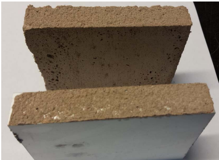
Figur 1.3 Brottytan vid kombinationen putsbruk och aluminium. Nederst på bilden visas hur putsbruket fastnar på aluminiumet.
