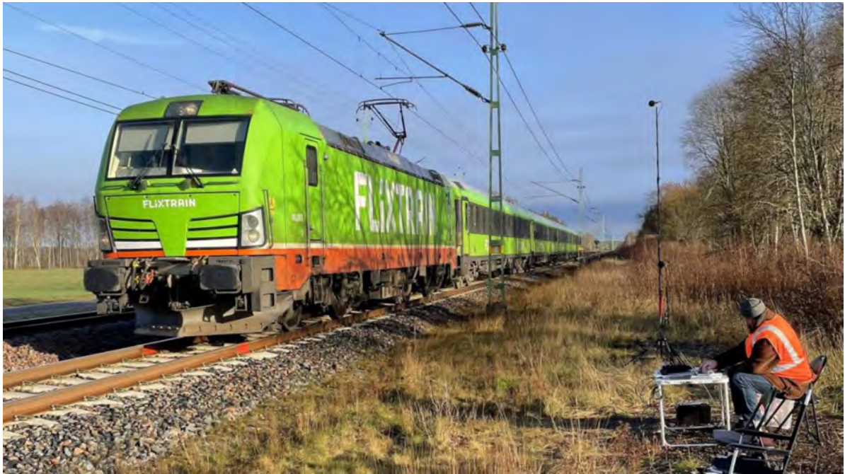
Figur 3. Mätning av bulleremission från Flixtrain persontåg utmed Västra stambanan.
