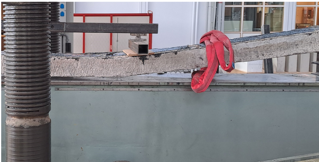
Figur 17. Närbild från böjförsök vid kraftig nedböjning
