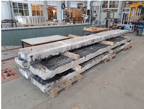
Figur 5. Provelement från 65 år gammal industribyggnad
