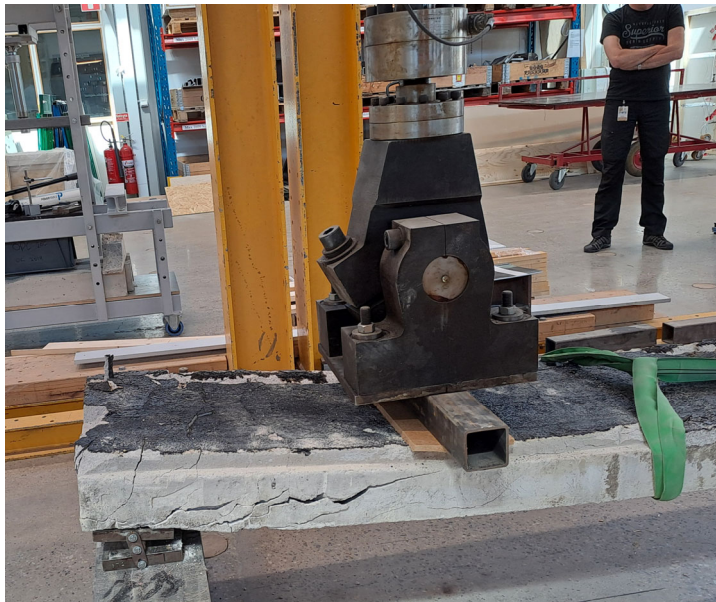
Figur 16. Skjuvbrott i takelement.
