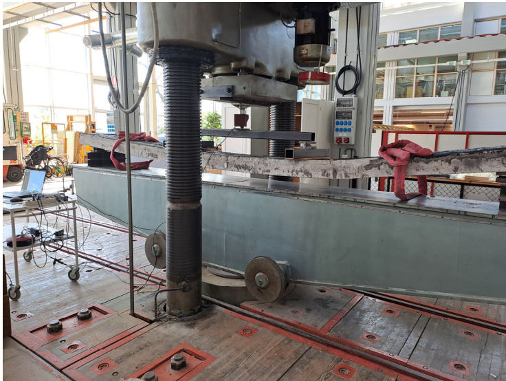
Figur 13. Böjtest av takelement i provningens slutskede
