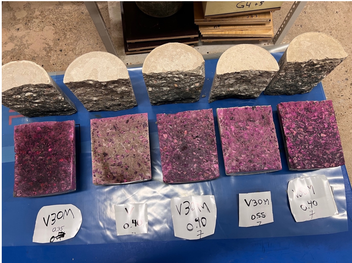
Fig 5.6 Spräckta provkroppar besprutade med fenolftalein efter avslutade vägningar
