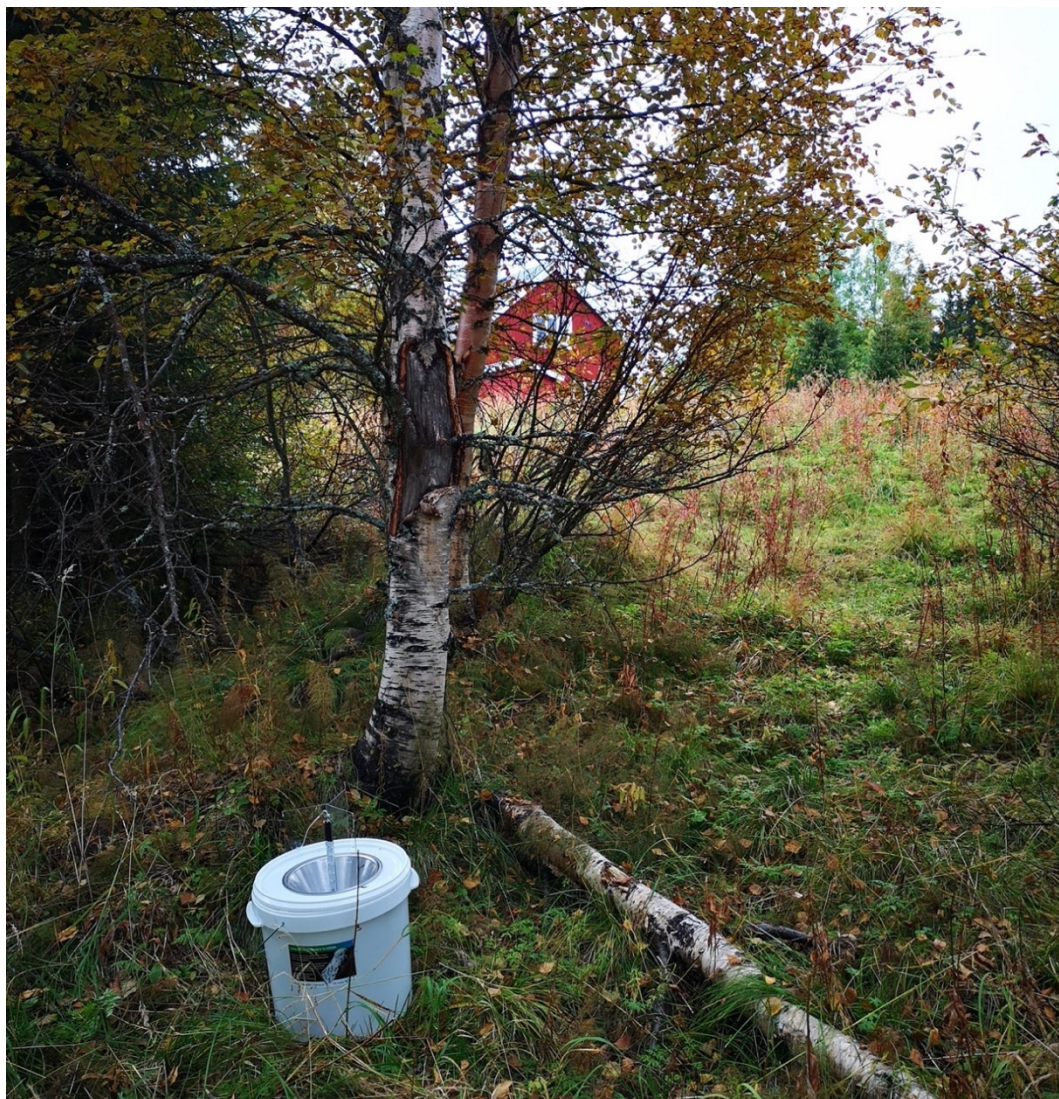
Figur 6. Portabel nattfjärilsfälla av typen LED-Emmer (Vlinderstichting, NL). Fällan är utförligt beskriven i: https://www.vlinderstichting.nl/wat-wij-doen/meetnetten/meetnet-nachtvlinders/ledemmers-info . Den drivs med en powerbank och aktiveras via en ljussensor. Fem LED-fällor per lokal är den inventeringsinsats som testats i Sverige samt den som för närvarande rekommenderas i EU-PoMS (Potts m.fl. 2020). Foto: Roger Marklund.
