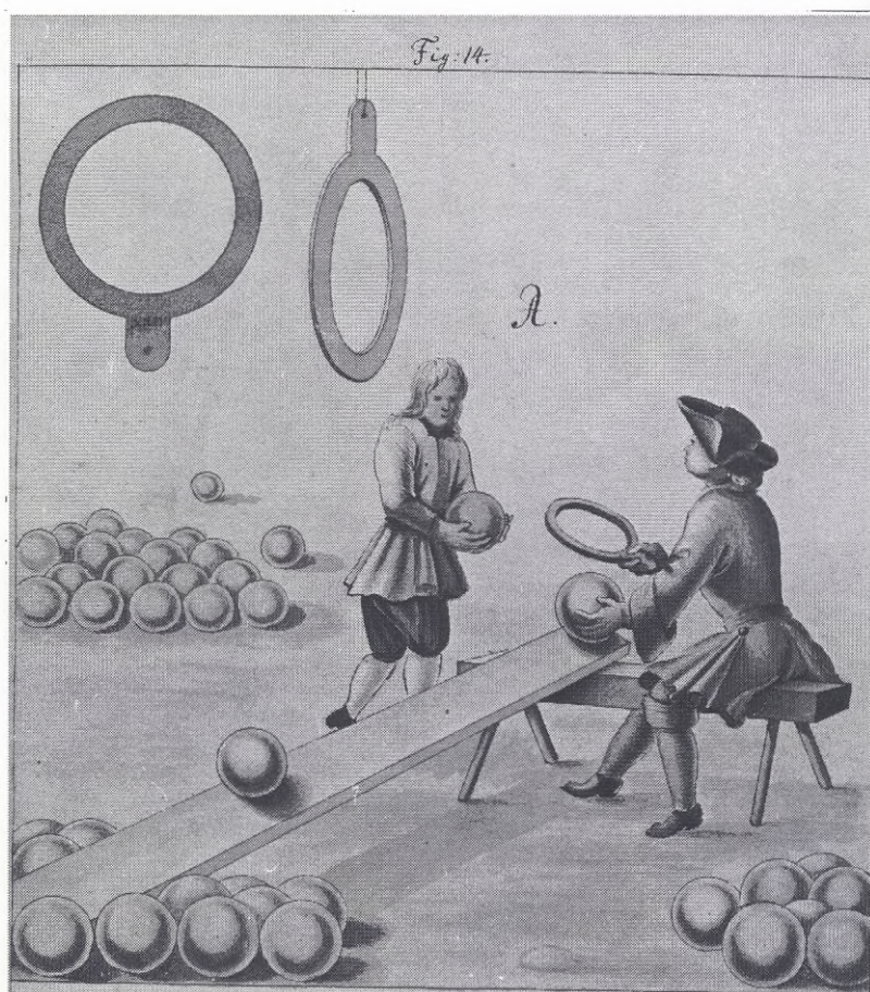
Fig. 7. Kanonkulevisitering ur en artilleribok från början av 1700-talet. 63 I nedre, högra hörnet ses de kasserade kulor som inte passerade genom diamettermallen.
