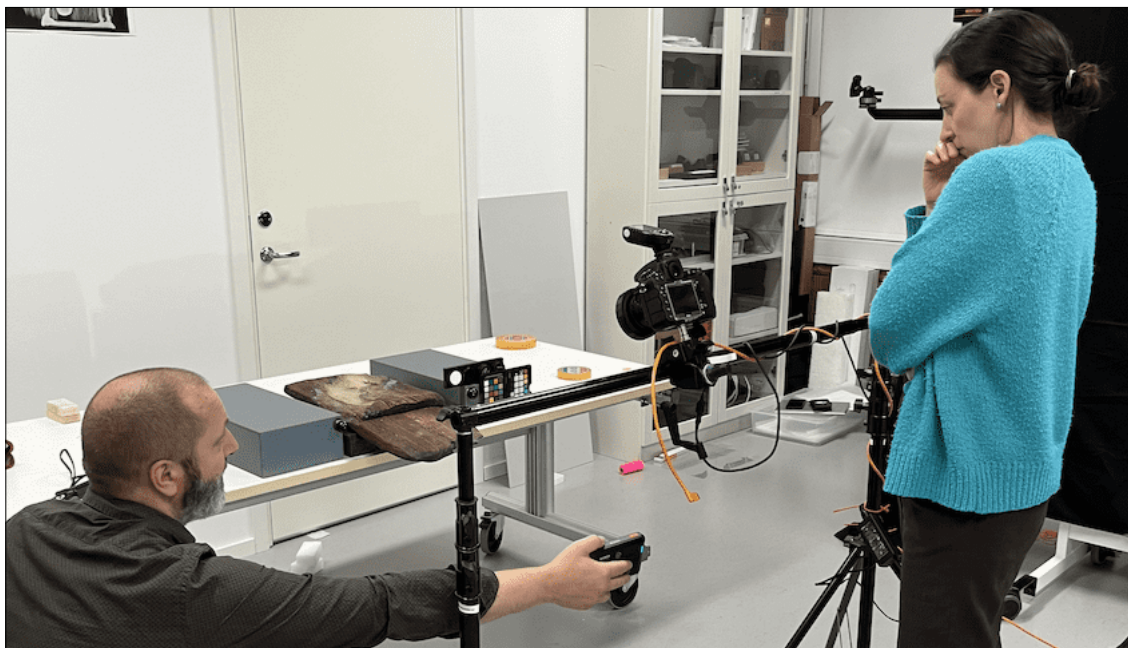
Fig. 9. Magnus Mårtensson och Elyse Canosa vid Riksantikvarieämbetets Kulturarvslaboratorium i Visby arbetandes med RTI-analyser av änden på plank D2. Foto: Peter d'Agnan.
