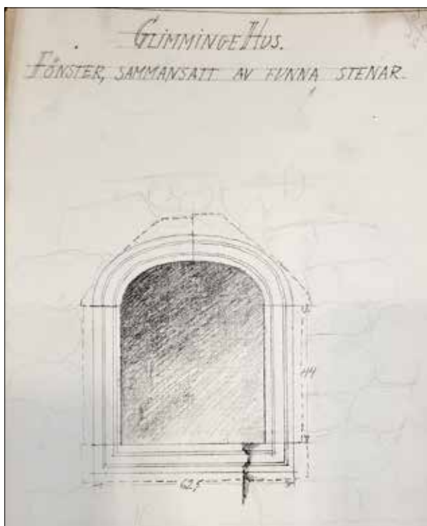
Fig. 3. Anjous skiss av den fönsteromfattning han sammanfogade av profilerade Komstadkalkstenar. Sten Anjou 1925, Antikvarisk topografiska arkivet, d. nr. 1756/1925. Public domain.
