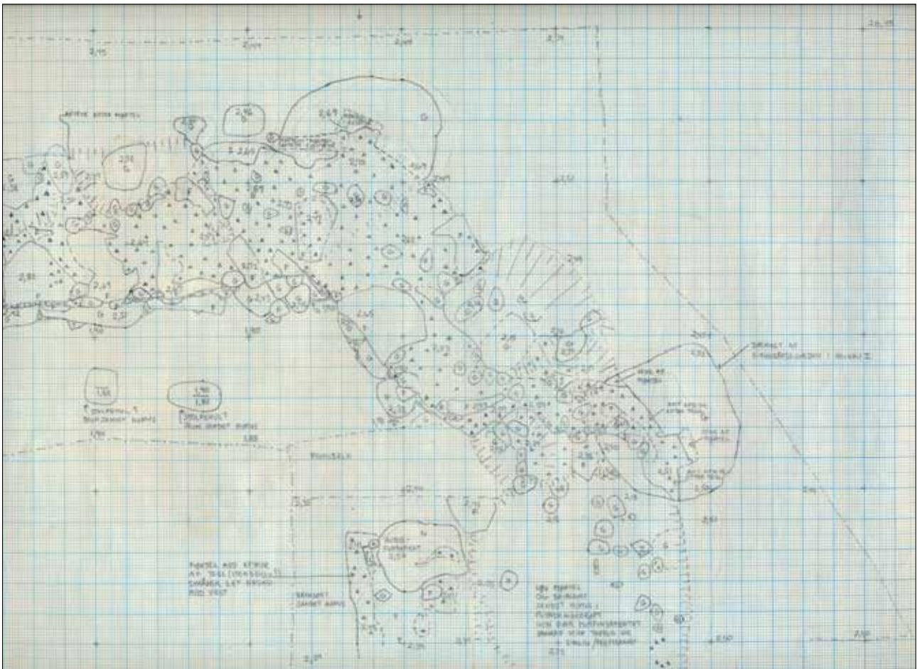
Fig. 6. Originaldokumentation av korets nordöstra hörn av Jes Wienberg från 1987. Högaltarets understa fundament i ursprungligt läge med kalkbruk uppstruken mot sockeln. Ritning: Jes Weinberg, Lunds universitets historiska museum.
