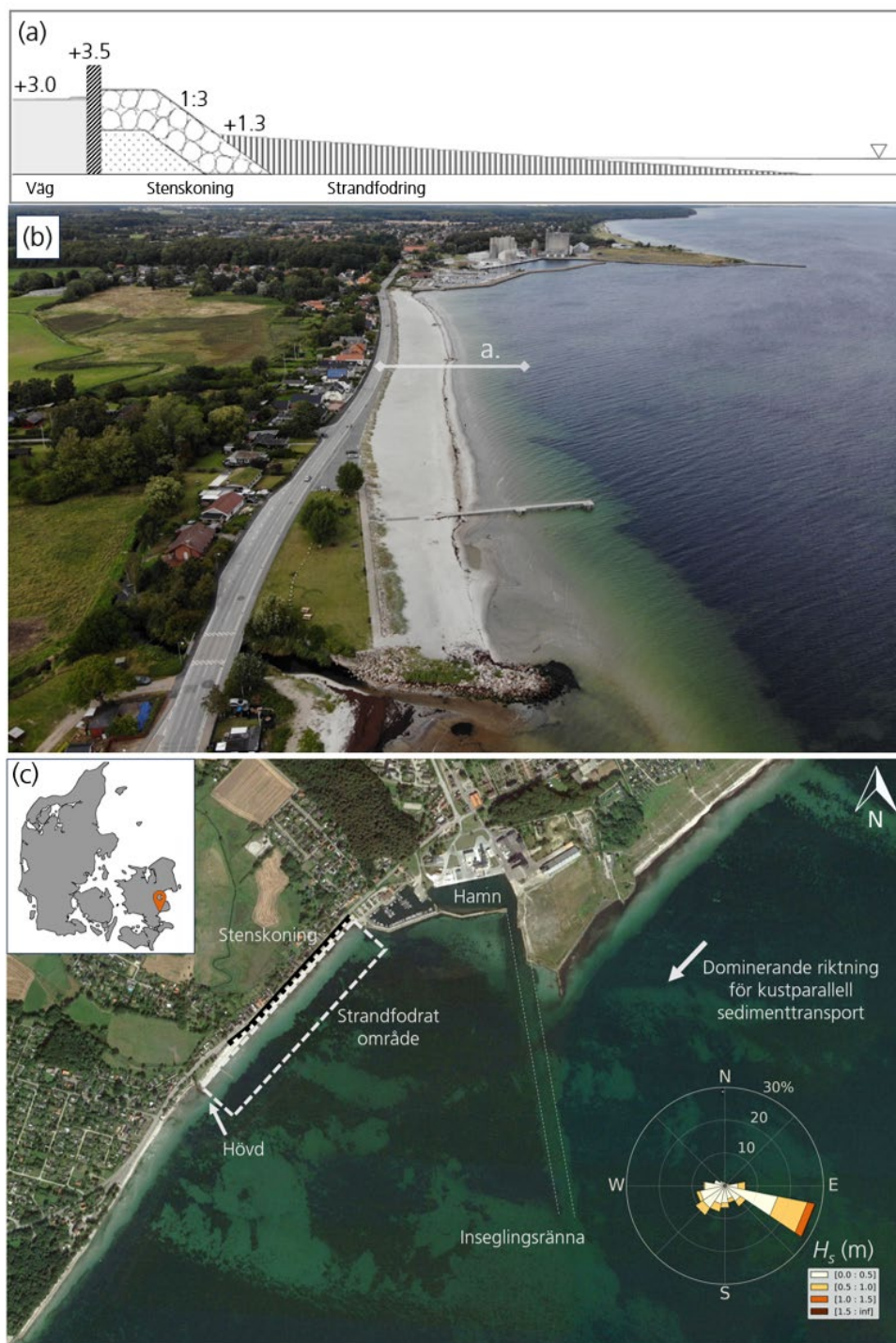
Figur 10 Fallstudie kustskydd Faxe Ladeplads, (a) visar schematisk utformning, (b) överblicksbild över den fodrade kuststräckan från juli 2021, foto: Kystdirektoratet, (c) karta över området.
