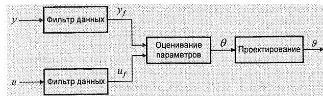
Рис. 3. Схема механизма уточнения параметров в самонастраивающемся регуляторе
