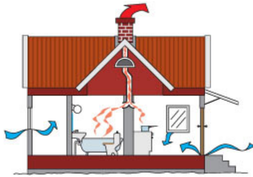
Figur 2: Schematisk bild över självdragssystemets funktion (Energimyndigheten, a).
