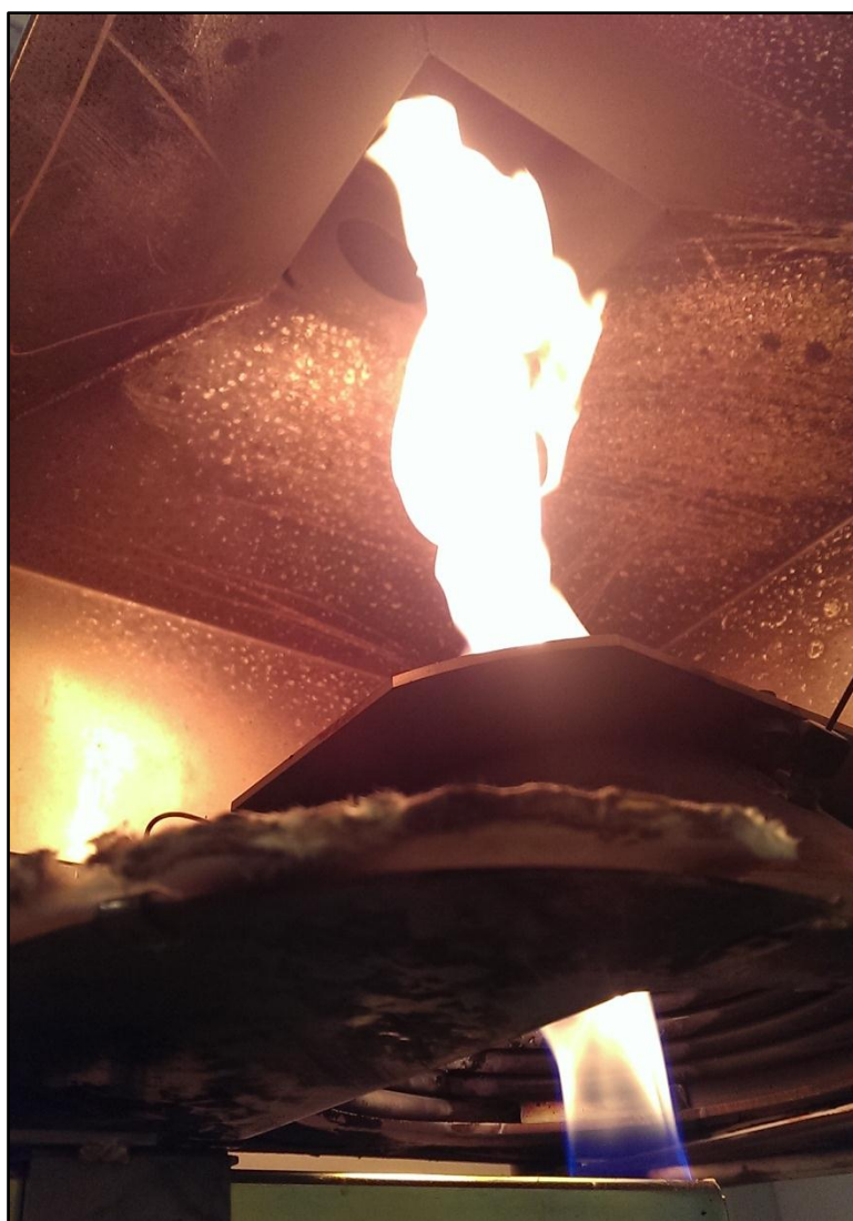
Figur 12: Den så kallade konkalorimetern används ofta vid provning av olika materials egenskaper vid brand.
