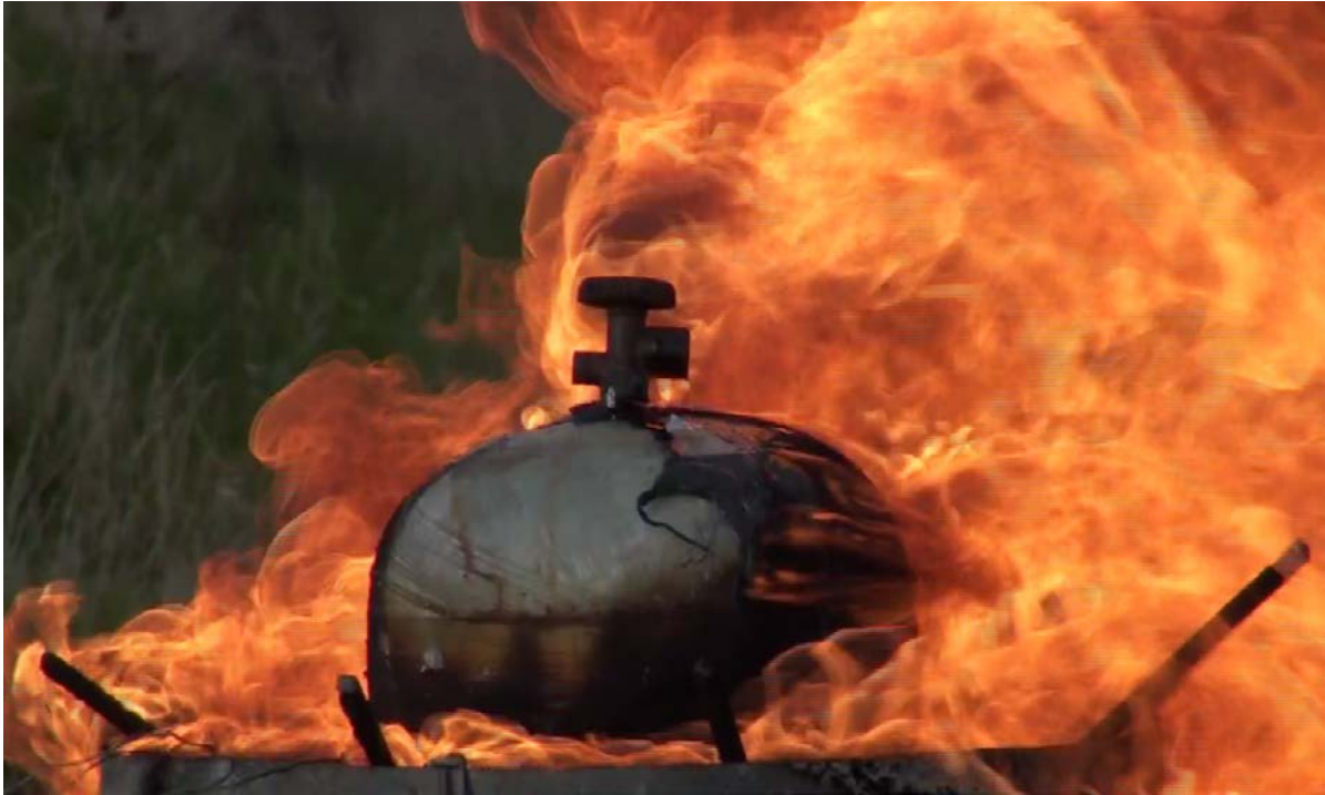
Figur 33. Anslutningsdelen har kantrat.
