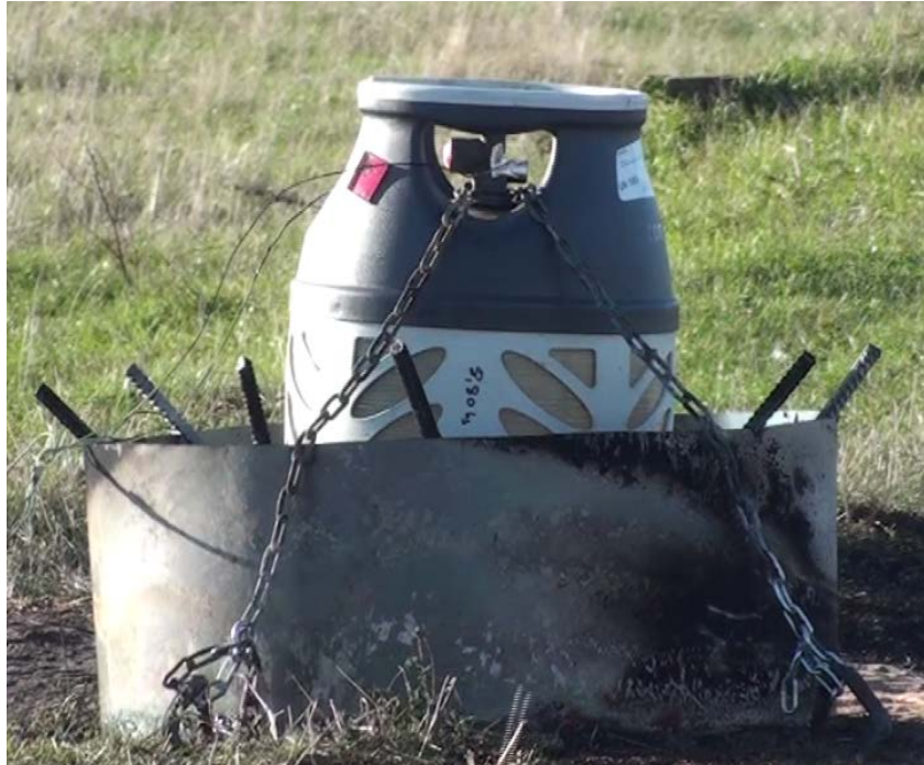
Figur 49. Brandprovning 4 med gasolbehållare PC5
