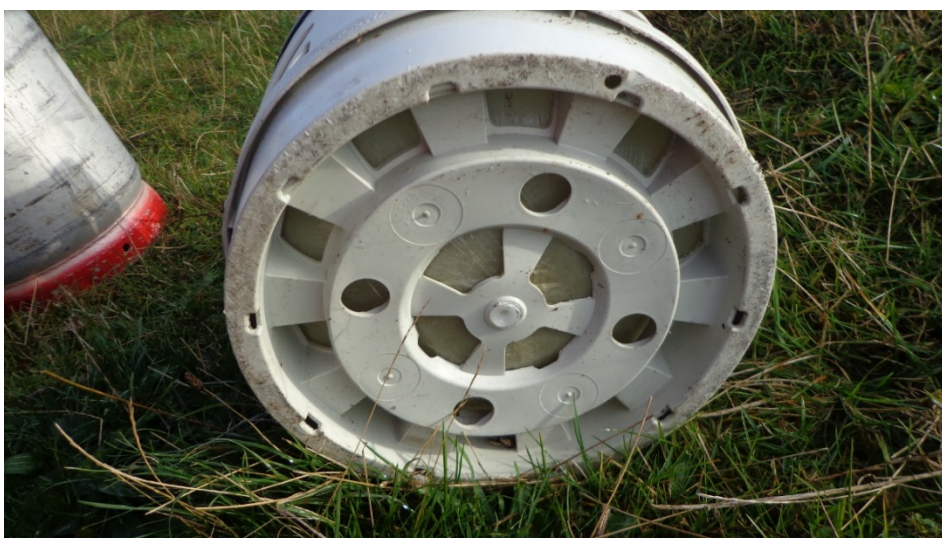
Figur 36. Ytterhöljet och den trycksatta delen har en trolig gemensam infästning i bottendelens centrum.
