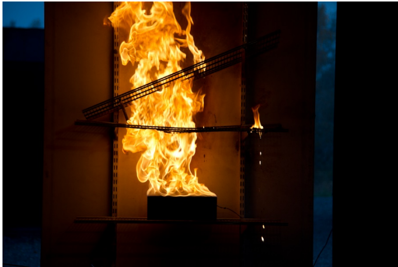
Figur 26. Butiksuppställning just efter explosion av aerosolbehållare.
