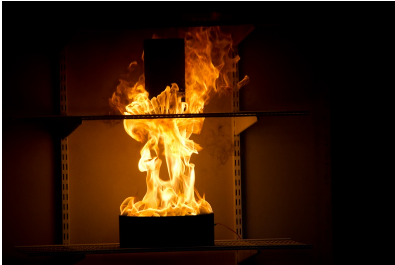
Figur 16. Aerosolbehållare exponeras för brinnande brandfarlig vätska.
