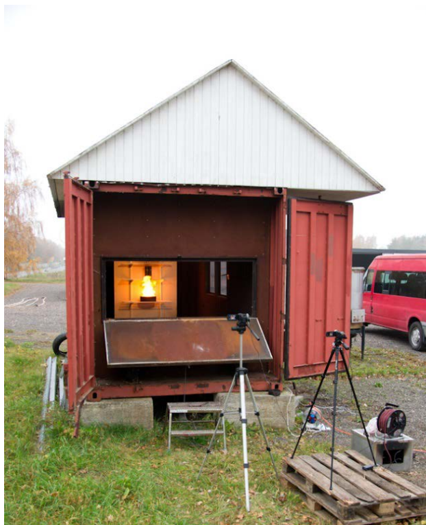
Figur 4. Butiksuppställning i container. Brandprovning just startat.
