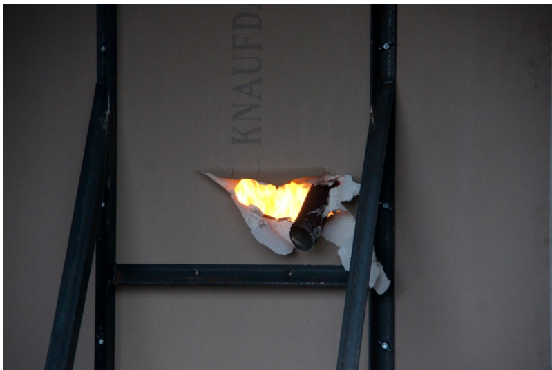
Figur 27. Aerosolbehållare har vid explosion penetrerat 13 mm gipsskiva.
