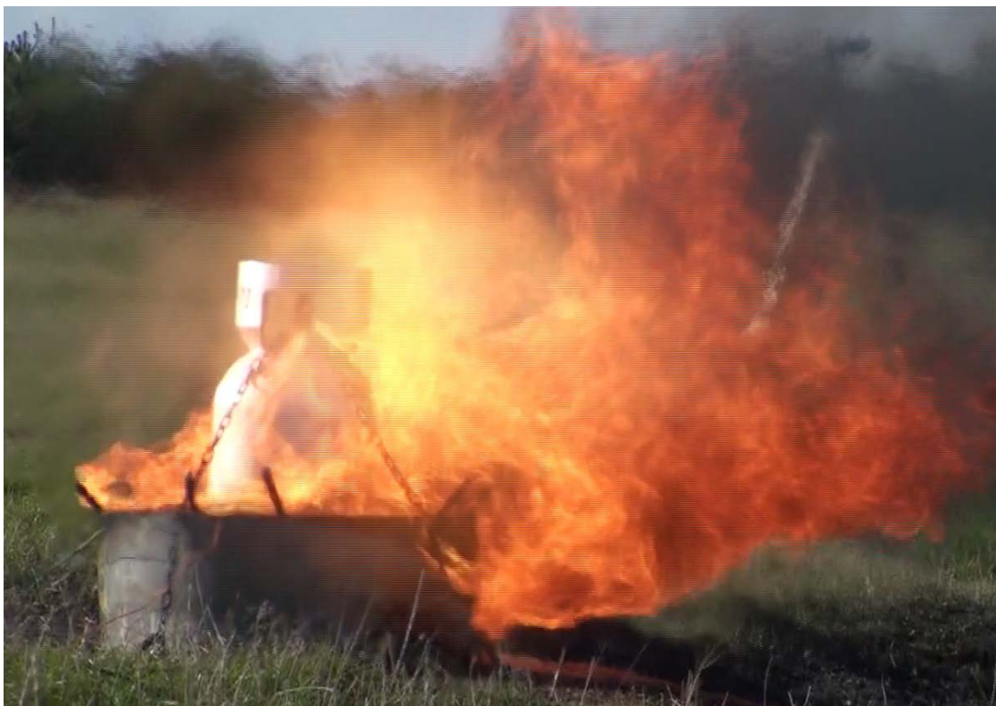
Figur 46. Säkerhetsventil öppnar och gasen antänds(ljusbula flammen vid behållarens övre del)
