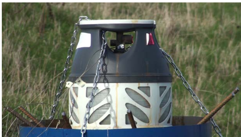
Figur 30. Försökuppställning med gasolbehållare PC5.
