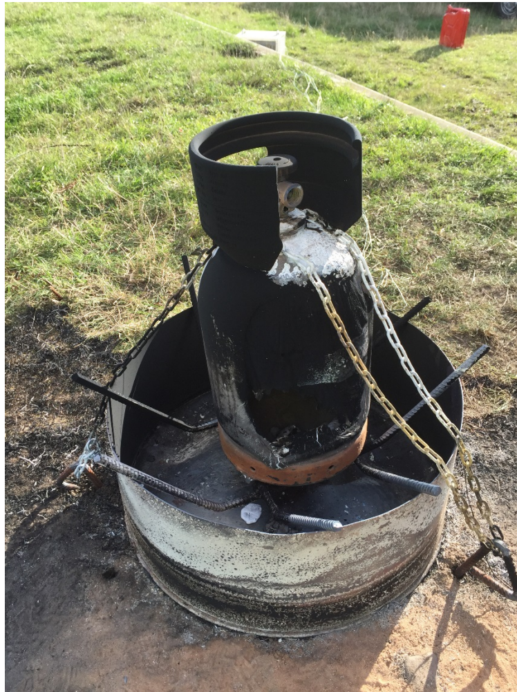
Figur 44. Gasolbehållare PA6 efter test med bortsmält sida.
