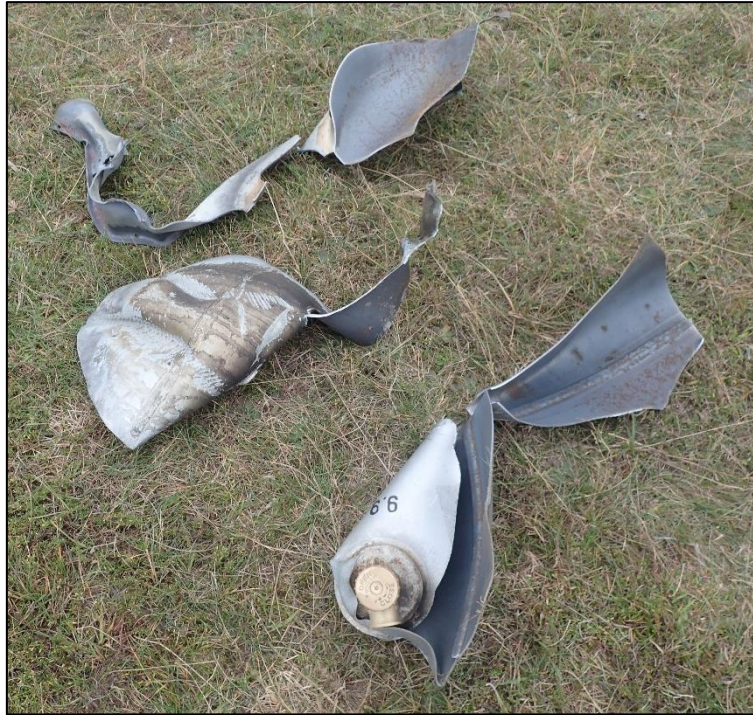
Figur 18: Ihopsamlade delar av stålflaskan.
