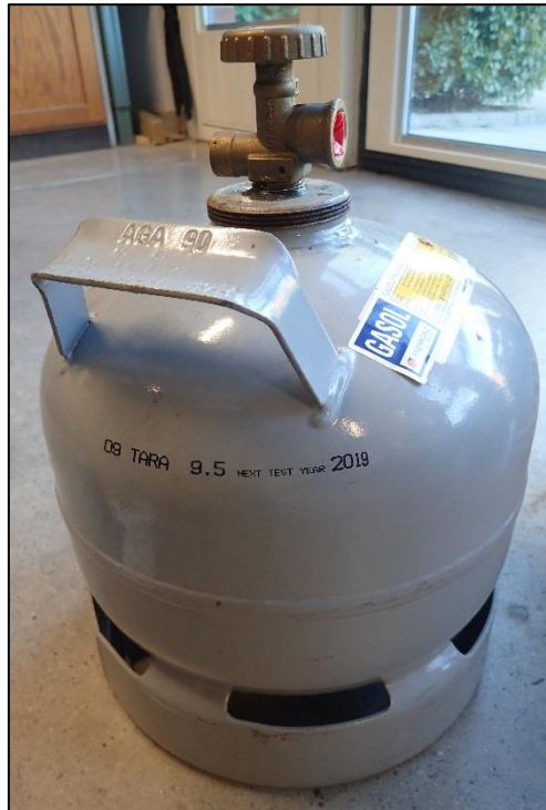
Figur 11: Flaska av stål, med säkerhetsventil.
