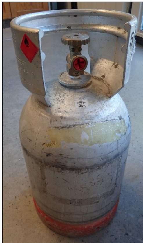
Figur 9: Flaska av aluminium med säkerhetsventil och smältsäkring.
