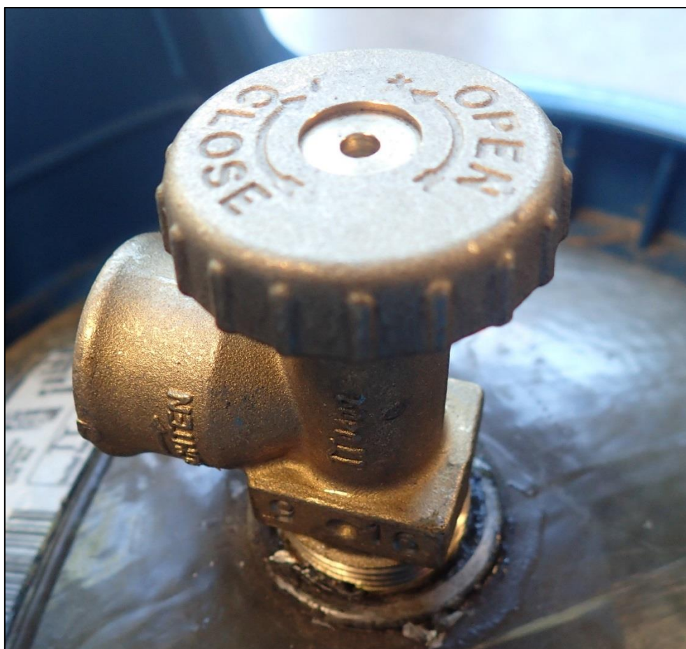
Figur 3: Flaskventil utan varken säkerhetsventil eller smältsäkring. Denna typ var monterad på flaskorna i försök 5 - 8.
