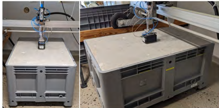
Figur 2. Betongprovkropp positionerad under LTH:s XY-skanner. Provkroppen mäter 1100x710x420 mm (innermått) och innehåller tre plåtar av varierande korrosionsnivå, se Figur 3. Figur från [4].
