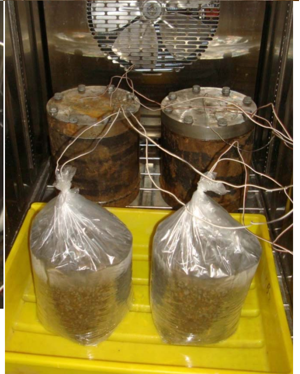
Bild 2. Prover testades i en stålbehållare (tv) eller i en plastpåse (th). I båda fallen var proverna omgärdade av grus och vatten. (Pålbrink & Rydman, 2013)
