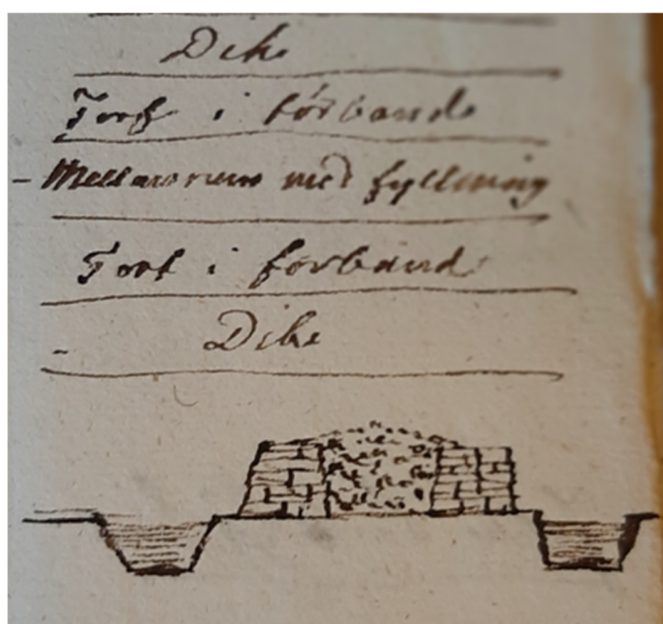
Figur 14. Teckning över en jordvall av torv förstärkt med stenmur och diken på vardera sida. Källa: Lantbruksakademin, Å. a. E II:I, Mekaniska avdelningen, obundet dokument (1814). Foto av författaren.
