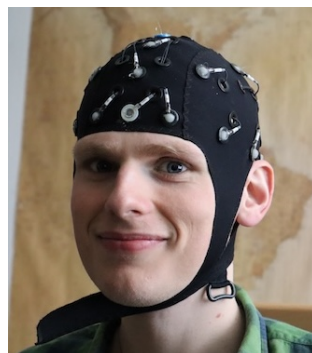
En användare bär en EEG-mössa som mäter de hjärnsignaler som styr BCI:n
