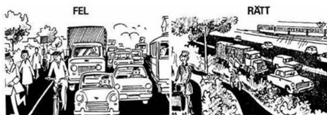
Figur 3: Separationsprincipen. Källa: Gunnarsson & Lindström 1970
