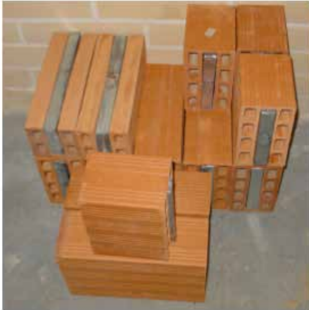
Figur 4.8. Integrerat PCM i byggmaterial [8].
