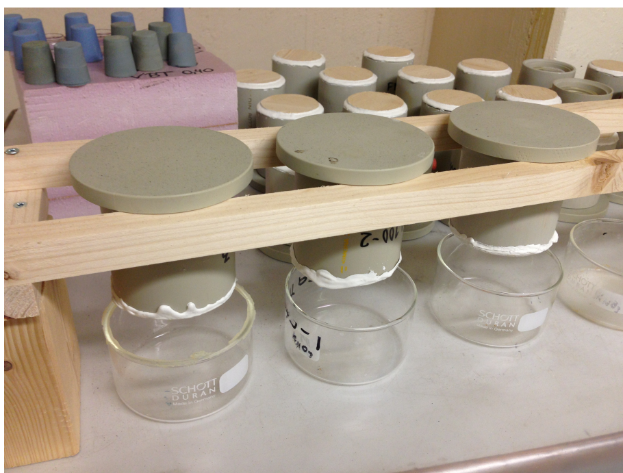
Fig. 3.5 Omvända koppar innehållande vatten, exponerade i klimatrum med 55 % RF
