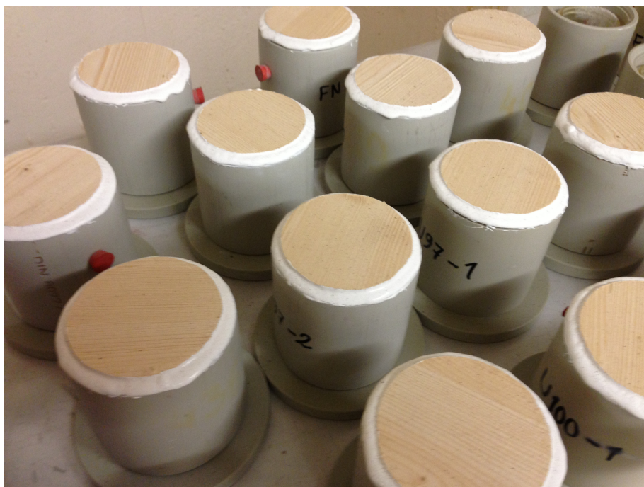
Fig. 3.4 Koppar exponerade i klimatrum med 55 % RF
