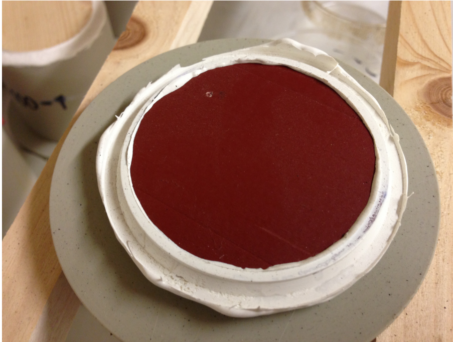
Fig. 3.3 Insidan av en målad rondell med tätningsmassa, formad efter koppens övre del
