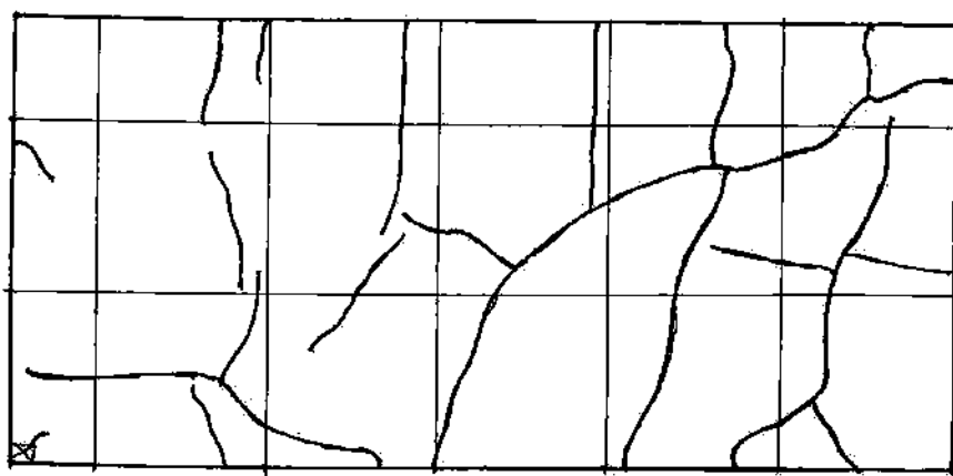
FIGUR 4. Sprickbildning i de första provväggarna.
