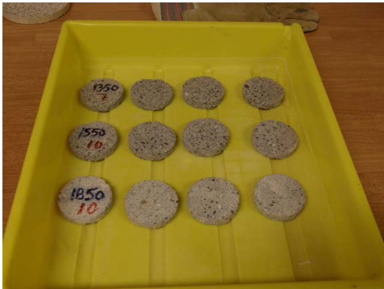
Fig. 4.1 Skivor sågade ur utborrade cylindrar för mätning av fukttransportegenskaper
