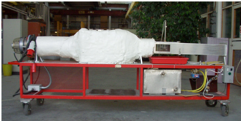
Figur 6.3 Vindtunnel som används för bestämning av RTI värden
