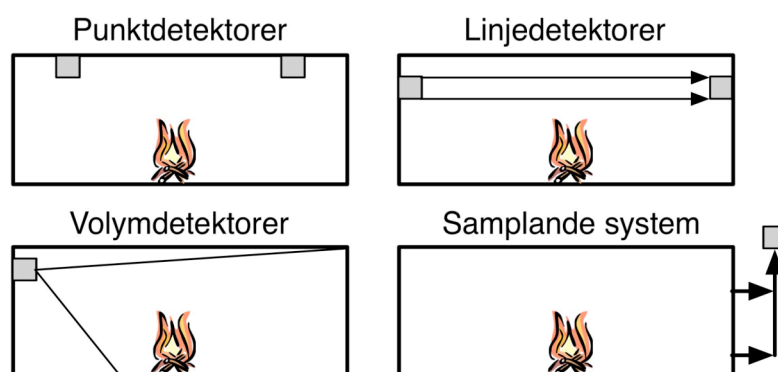
Figur 2.2 Principerna för punktdetektorer, linjedetektorer, volymdetektorer och samplande system. Detektorerna är grå kvadrater i bilden.
