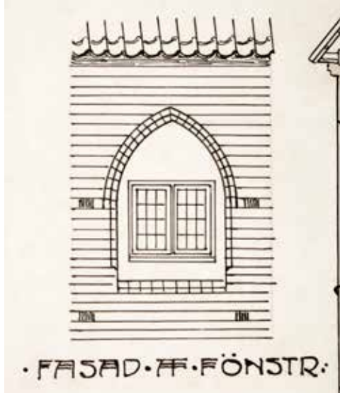
Slutgiltig och enklare utformning av ovanvåningens fönster i den östra fasaden. Detalj ur "Förslag till inredning", Wählin 24.12.1909. Historiska museet.
