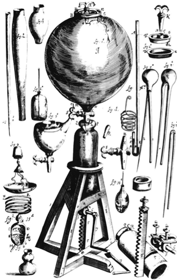
Fig. 6. Robert Boyles första lyckade luftpump, även kallad pneumatisk maskin ( pneumatical engine ) eller helt enkelt machina Boyleana . Den krävde inte nedsänkning i vatten som von Guericke:s tidigare hade gjort och gav förutsättningarna till 43 olika experiment genom att olika saker som barometrar och klockor kunde föras in i det evakuerade utrymme. Ur Robert Boyle, New Experiments Physico-Mechanical (1660).
