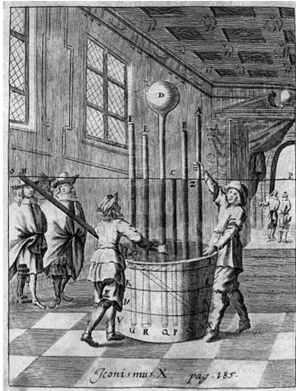
Fig. 3. Vincenzo Vivianis och Evangelista Torricellis berömda experiment i Florens med kvicksilverpelare i glasrör våren 1644. Ur Gaspar Schott, Technica Curiosa (1664).
