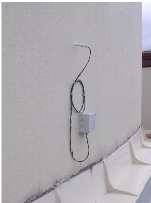
Figur 5.3.10. Placering av mätpunkt i förhållande till anslutning mellan inneslutningsvägg och bränslebyggnadens tak, nivå +131 m.
