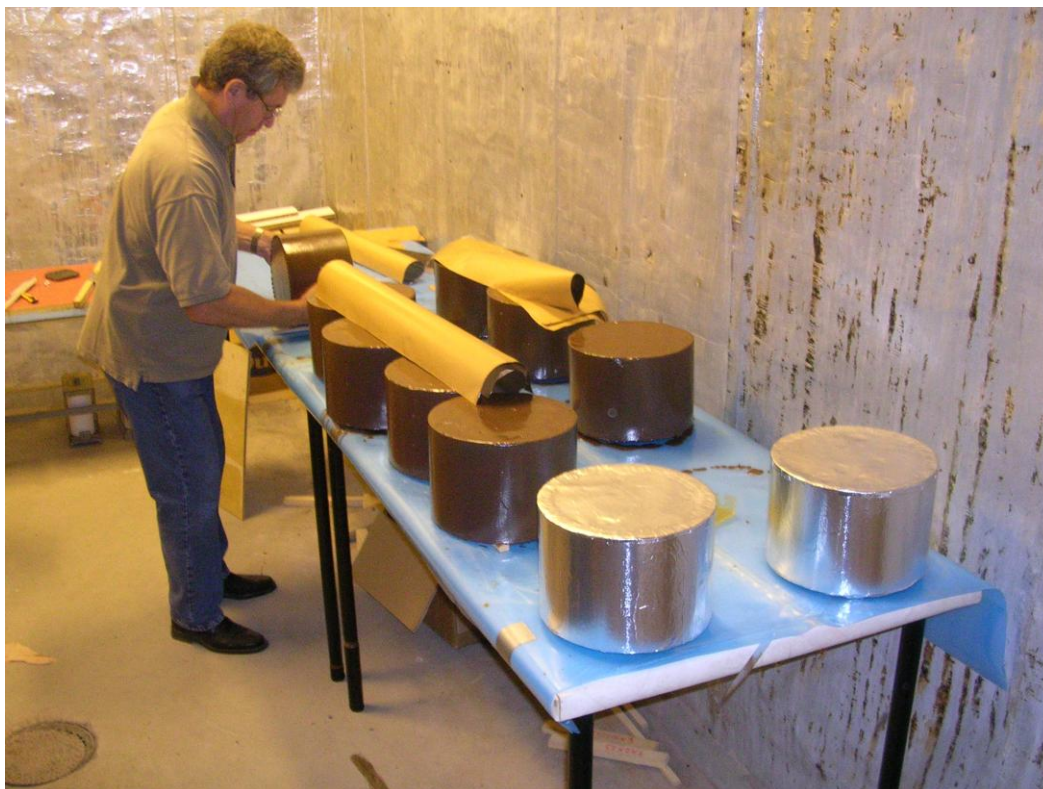
Fig. 4.1.2 Arbetet med försegling av provkropparnas alla ytor utom den blivande torkytan
