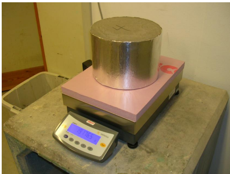
Fig. 4.1.3 En färdigförseglad provkropp med torkytan uppåt, kortvarigt exponerad för laboratorieklimat under vägningstillfället.
