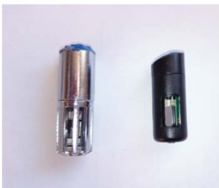
Figur 10. Närbild på avsågad del av Vaisala-sensor (till vänster) och Testo-sensor (till höger).
