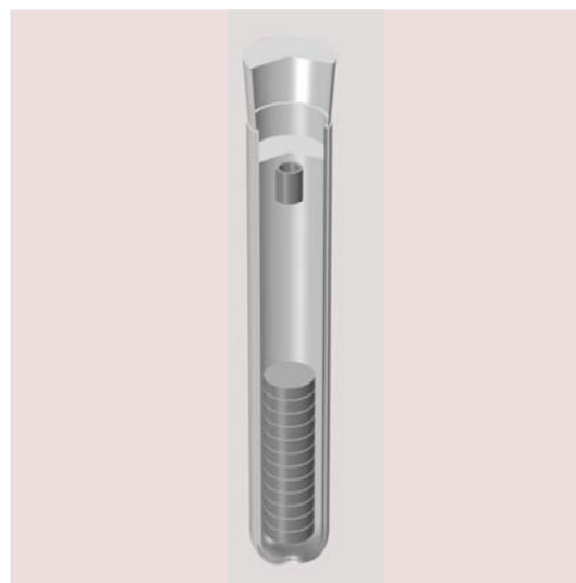
Figur 31. 3D-visualisering av provrör, halv provmängd betong, sensor och gummiplugg.
