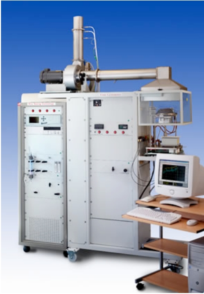
Figur 2 ISO 5560 part 1 utan inbyggt skåp runt kon kalorimeter (bild FTT, med tillstånd av FTT)
