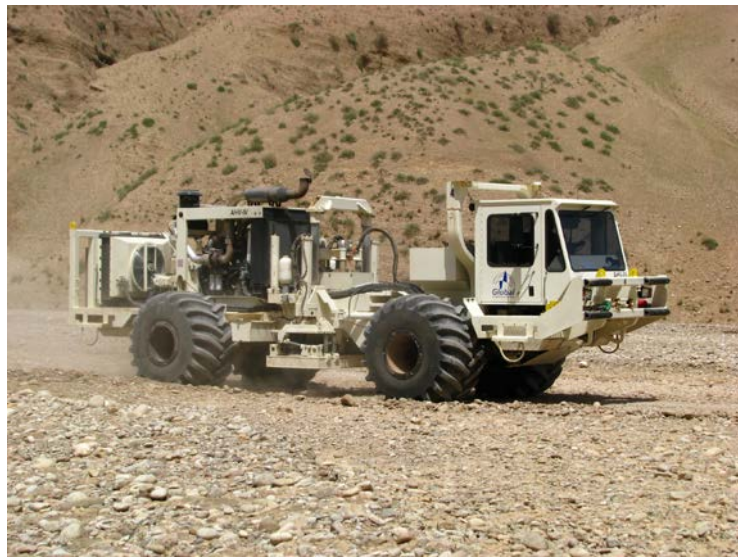
Figur 3.2. Vibroseistruck 3 – 150 Hz. Chassiet lyfts upp med domkrafter och hela ekipaget vilar på plattan mellan hjulpären. Plattan överför vibrationerna till marken. The chassi is lifted and the vehicle rests on the circular plate between the wheels.
