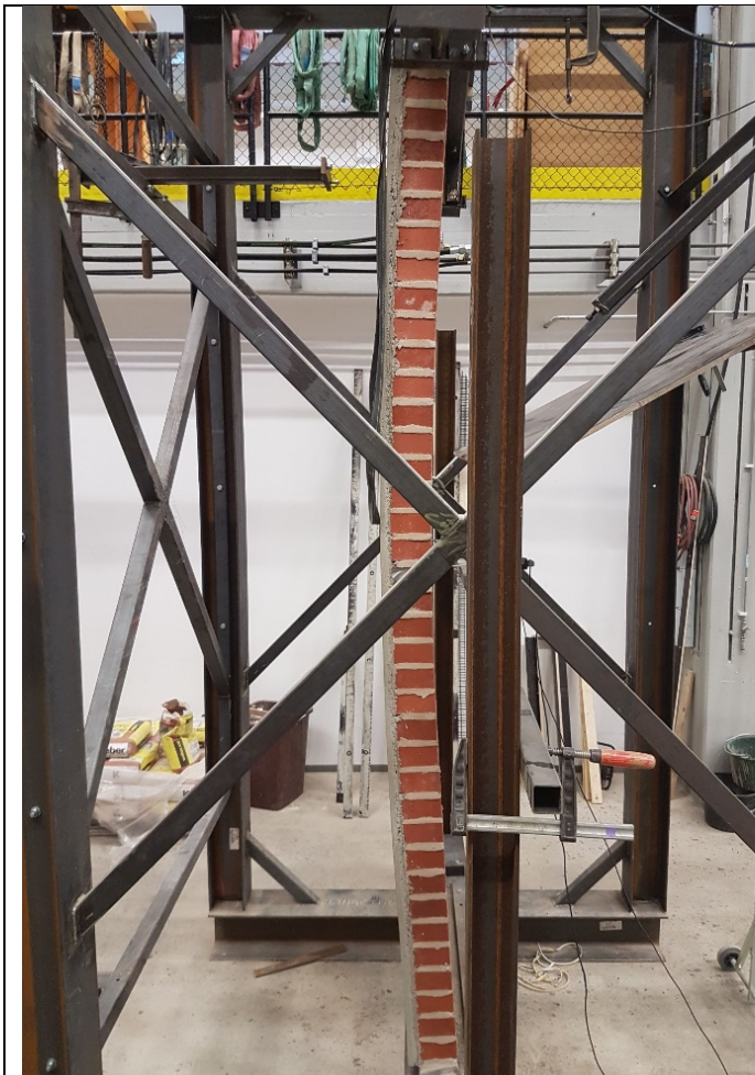
Bild 23. Cirka 60 mm utböjning för förstärkt testvägg murad med svagt murbruk (M0.5) – förstärkningen finns på väggens vänstra, putsade yta.
