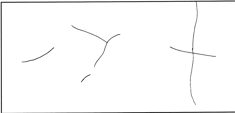
FIGUR 7b. Sprickbildning i vägg 1 två dygn efter det att uttorkningen startade.
