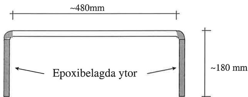
Figur 1. Armeringsbyglar ingjutna i betongbalkar vid RV 40
