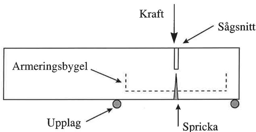
Figur 2. Tillverkning av spricka i armerad balk
