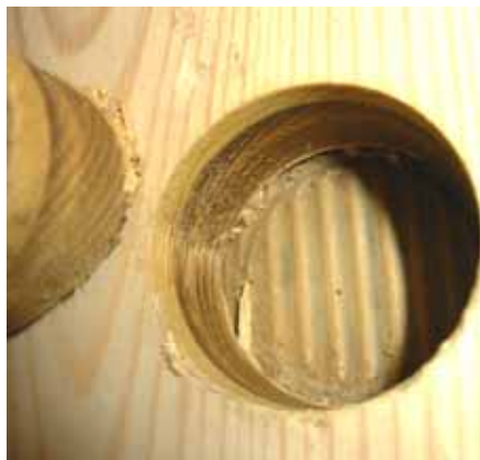
Figur 7.1.2 Från ett försök till vidhäftningsprovning på en massiv bräda där limmet inte ens var i kontakt med brädan.
