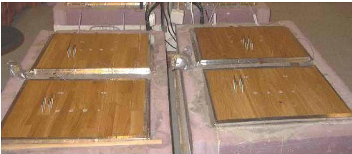
Figur 8.2 Två av provplattorna med löslagda (nedtill) respektive limmade (upptill) 3-stavs- (vänster) och 1-stavs lamellgolv, foto Demmrich (2006).
