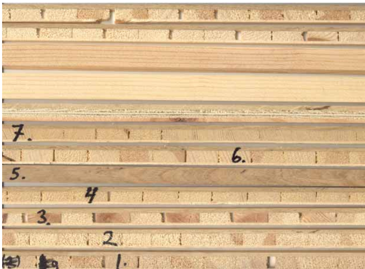
Figur 4.3.2 Längdsnitt av de tolv tillhandhållna trägolven, numrerade 1-12 underifrån
