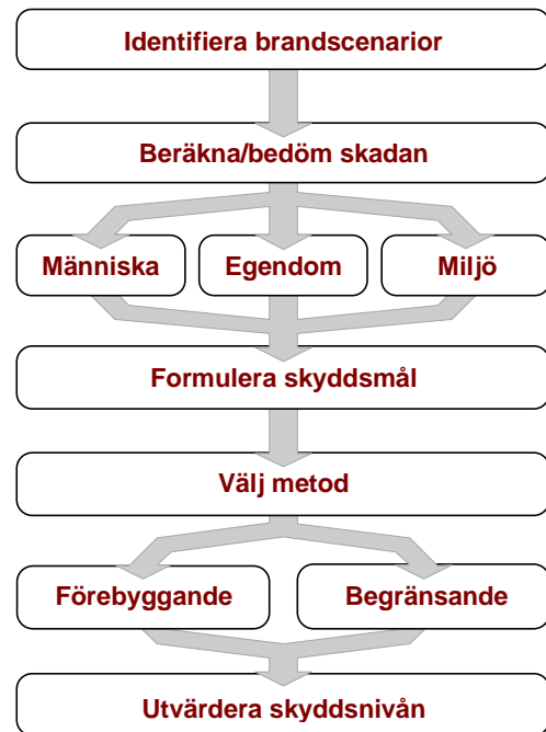
Figur A. Grundprincipen för brandriskanalys.
