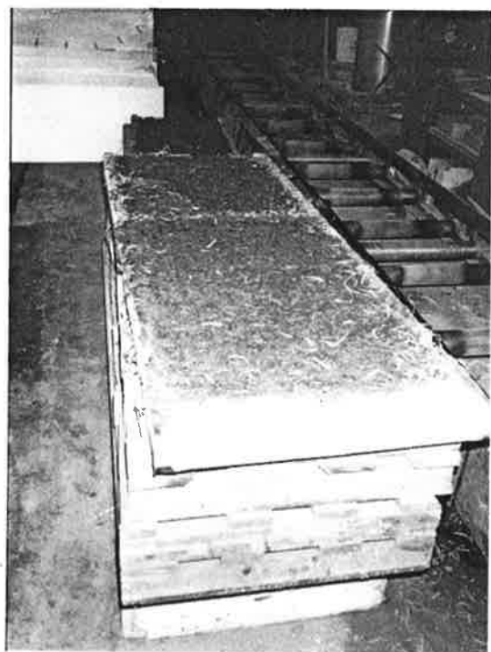
Fig 12. Ullen pressades samman med en tyngd som lades på formen (vänster). Högra bilden visar plattan efter ett dygn i form. Efter tre dygn kunde den avformas.
