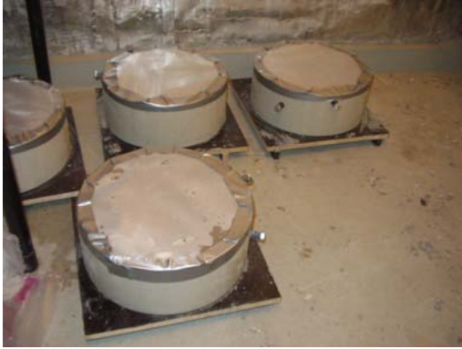
Figur 5.6 Membranhärdning av referensprovkroppar.
