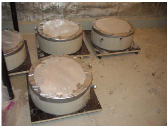
Figur 7.2 Membranhärdning av provkroppar genom försegling av överytan
