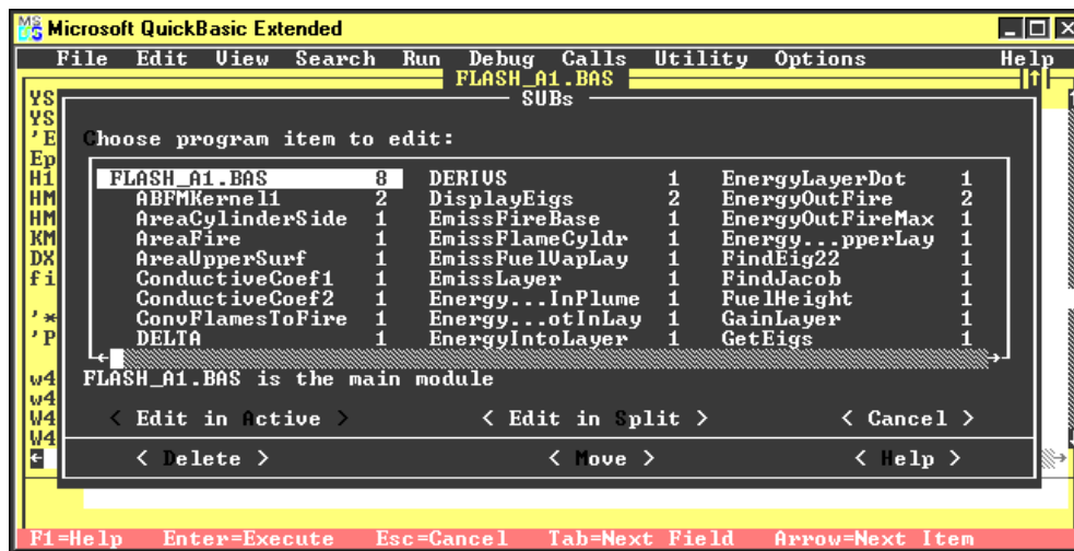
Figur E.1, Skärmbild från Flashover A1 som visar en del av de underprogram, subs, som används i programmet /E.1/.
